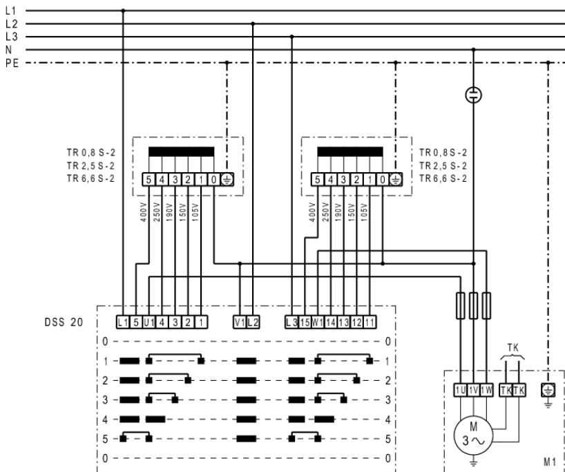
DSS 20    5-Stufenschalter; Switches for 5 steps; Commutateur à 5-étages
