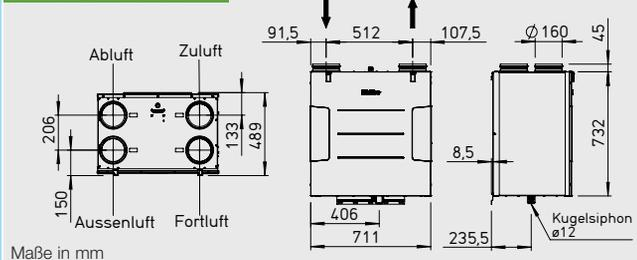
**Kompaktgeräte mit Wärmerückgewinnung für die zentrale Be- und Entlüftung von Wohnhäusern und Etagenwohnungen. Zertifiziert gemäß Passivhaus-Standard. Ausgestattet mit Helios easyControls, dem innovativen Steuerungskonzept für einfache Netzwerkanbindung und Webbrowser-Bedienung. Wahlweise mit hocheffizientem Kunststoff- oder Enthalpie-Wärmetauscher für zusätzliche Feuchterückgewinnung. Mit energieeffizienten EC-Motoren und Konstant-Volumenstromregelung.**
